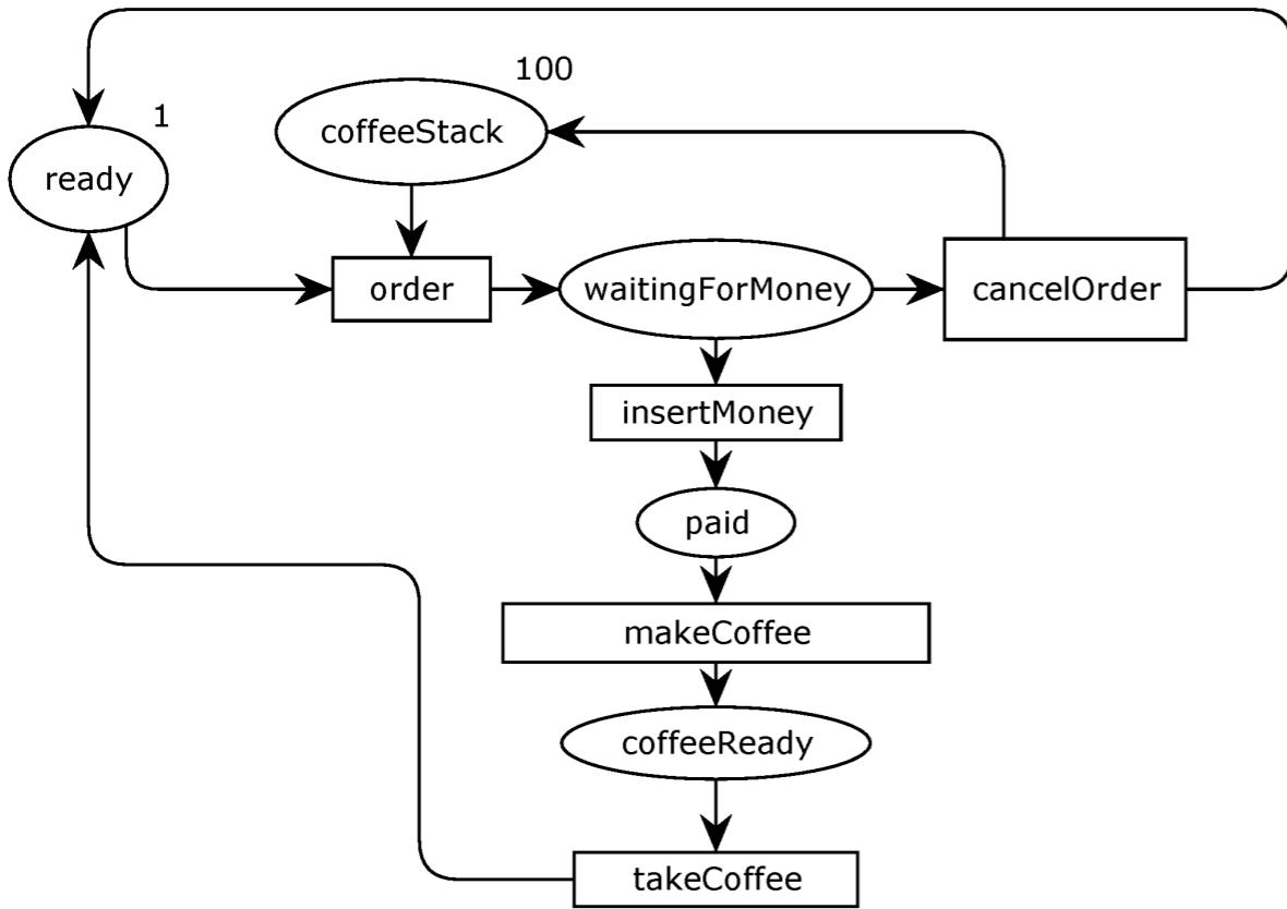
Poništenje vraća automat u stanje "ready". Ako je novac ubačen, automat priprema kavu (izvodi makeCoffee). Na kraju, izvođenjem takeCoffee, mušterija uzima pripremljenu kavu i automat se vraća u stanje "ready".
